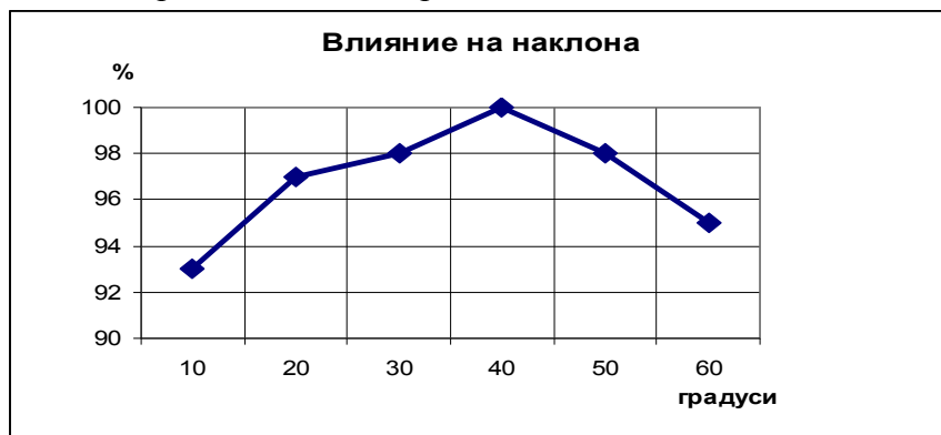
Фигура 2: Влияние на ъгъла на наклона върху количеството на приетата слънчева енергия
