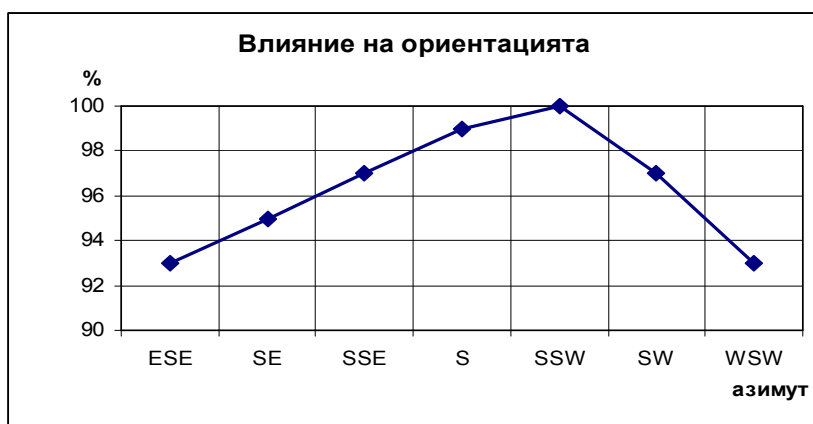
Фигура 1: Влияние на ориентацията върху количеството на преобразуваната слънчева енергия
